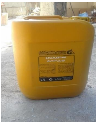
شکل ۱: الیاف فولادی بکار رفته در بتن HPFRCC شکل ۲: فوق روان کننده دیرگیر استفاده شده در نمونه‌ها
