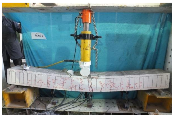
ج- لحظه انهدام تیر نمونه دوم ادامه شکل ۷: تصاویری از لحظه گسیختگی میلگرد GFRP و انهدام نمونه ها
