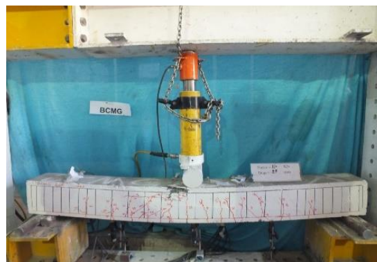
الف- لحظه گسیختگی میلگرد GFRP و انهدام نمونه اول
