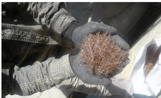
شکل ۱: الیاف فولادی بکار رفته در بتن HPFRCC شکل ۲: فوق روان کننده دیرگیر استفاده شده در نمونه‌ها
