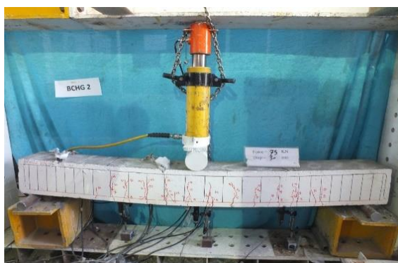
ب- لحظه گسیختگی میلگرد GFRP در نمونه دوم
