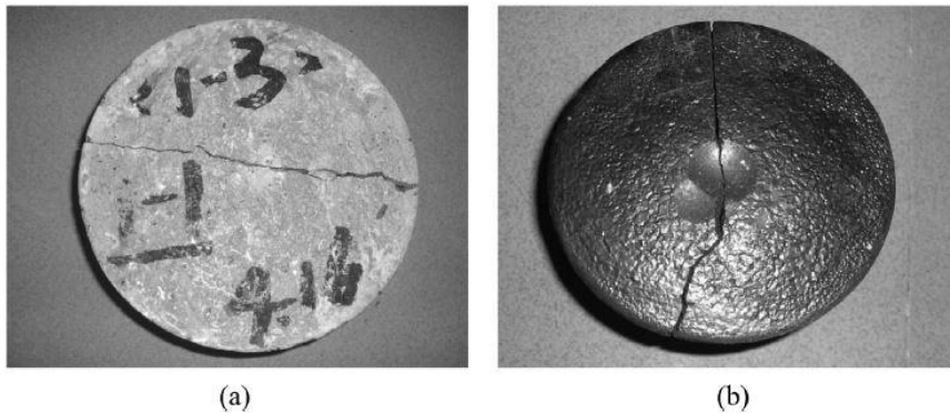
شکل ۱۲- نمونه ها بعد از ضربه، (a) نمونه بتنی، (b) نمونه ملات قیر-سیمان [۲۹]
