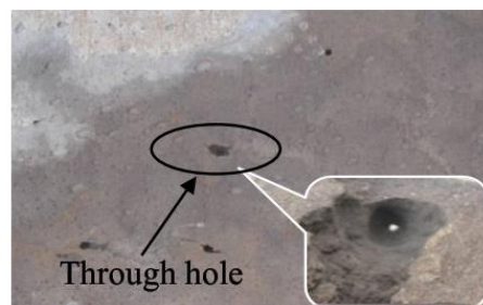
شکل ۵- تشخیص کیفیت نامناسب به علت خیس کردن نامناسب [۲۸]
