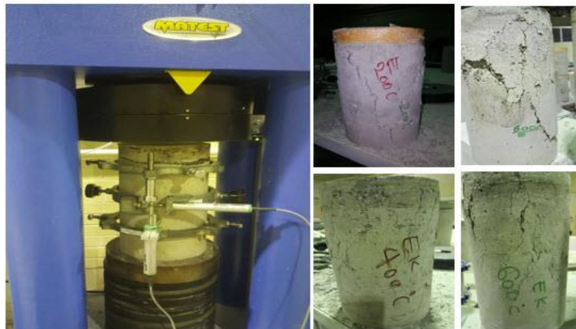
شکل ۷ - تست مقاومت فشاری
