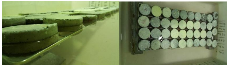
شکل ۵- طریقه قرار گیری قرص بتنی در آب
