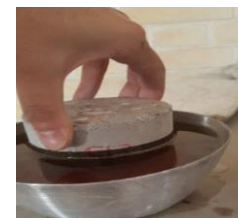
شکل ۴- آب‌بندی قرص بتنی توسط پارافین
