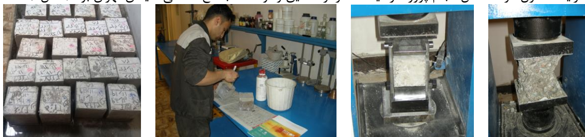
شکل ۳- نماهایی از عملیات آزمایشگاهی (از راست به چپ: تعیین مقاومت فشاری، مقاومت کششی، نرخ جذب آب)
