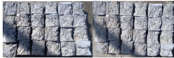
شکل ۵- بررسی ظاهری آزمونه‌های تحت تنش فشاری (به ترتیب از راست به چپ: N35، N50، N60، N67، N70 و N80)
