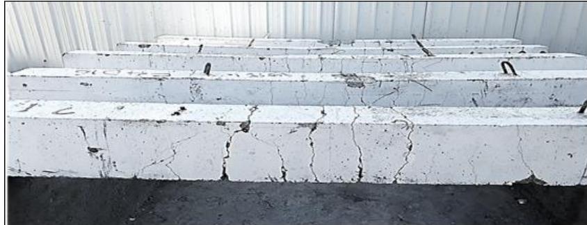
شکل ۵ - پنج نمونه تیر بتنی آسیب دیده جهت انجام مطالعات آزمایشگاهی
