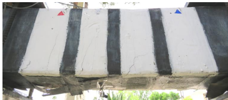
شکل ۲۲- ترک های متناظر و جدانشدگی FRP در نقطه D در نمودار نیرو-جابجایی تیر شماره یک تحت بارگذاری رفت و برگشتی
