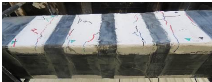
شکل ۲۱- ترک های متناظر و جدانشدگی FRP در نقطه C در نمودار نیرو-جابجایی تیر شماره چهار تحت بارگذاری رفت و برگشتی
