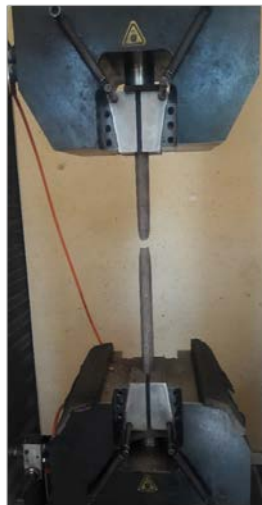
تصویر (۱۱) - انجام آزمایش کشش (آزمایش کوپان روی میلگرد استخراج شده)
