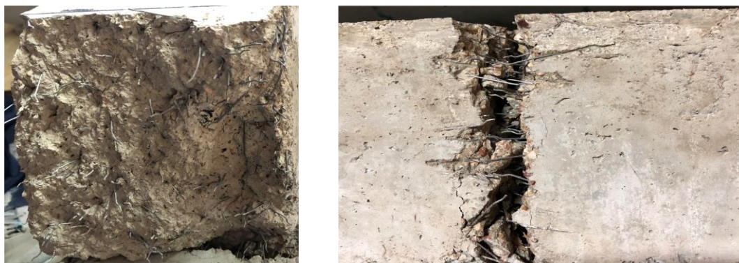
شکل-۵- مقطع گسیخته شده‌ی تیر بتنی با الیاف قلابدار
