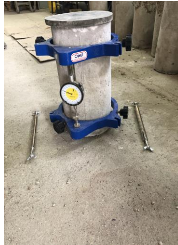
شکل ۹- آزمایش تعیین مدول ارتجاعی
