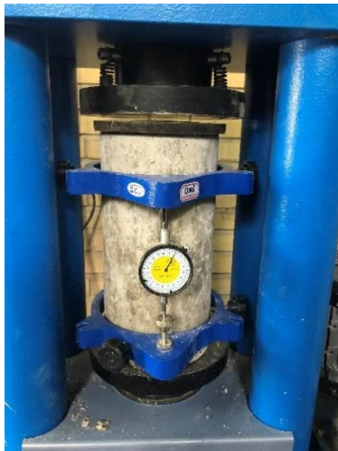
شکل ۹- آزمایش تعیین مدول ارتجاعی
