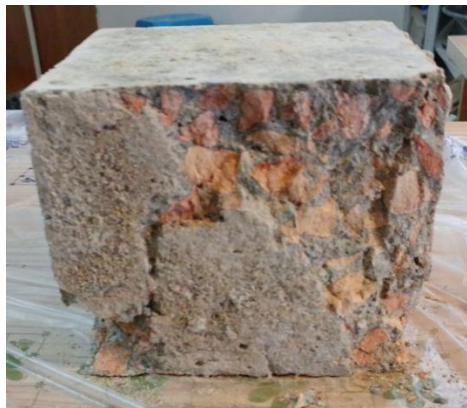
شکل ۲- نمونه بتن ژئوپلیمری باز یافتی شکسته شده
