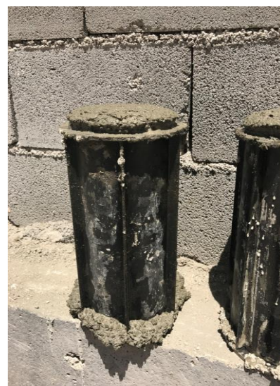
شکل ۱۰. تولید حباب در بتن حاوی ضایعات کامپوزیت - آلومینیوم
