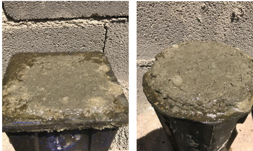
شکل ۱۰. تولید حباب در بتن حاوی ضایعات کامپوزیت - آلومینیوم
