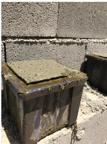
شکل ۱۱. بالا آمدگی بتن از سطح تراز شده ی قالب
