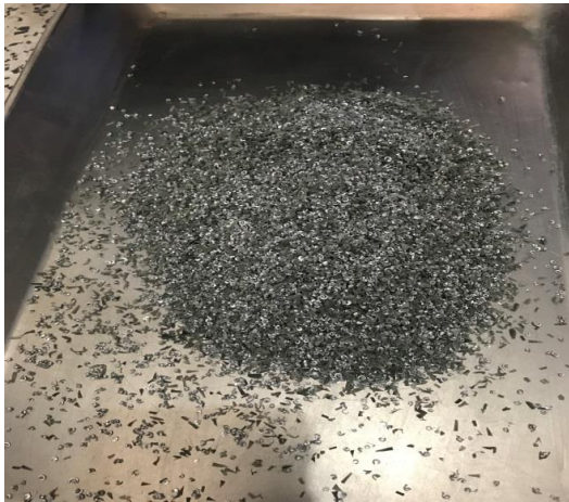
شکل ۲. ضایعات حاصل از برشکاری ورق کامپوزیت آلومینیوم
