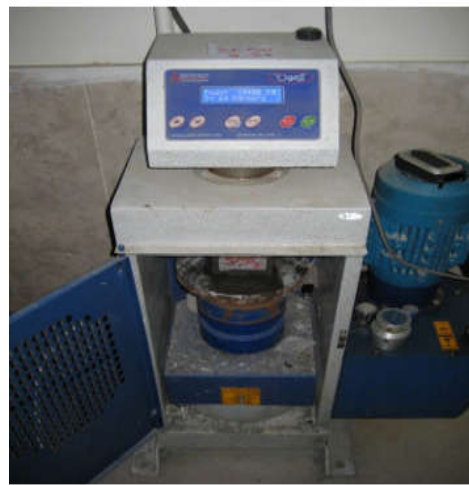
شکل ۵- شکست نمونه بتنی برای تعیین مقاومت فشاری
