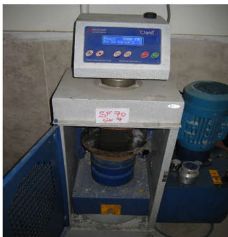
شکل ۵- شکست نمونه بتنی برای تعیین مقاومت فشاری
