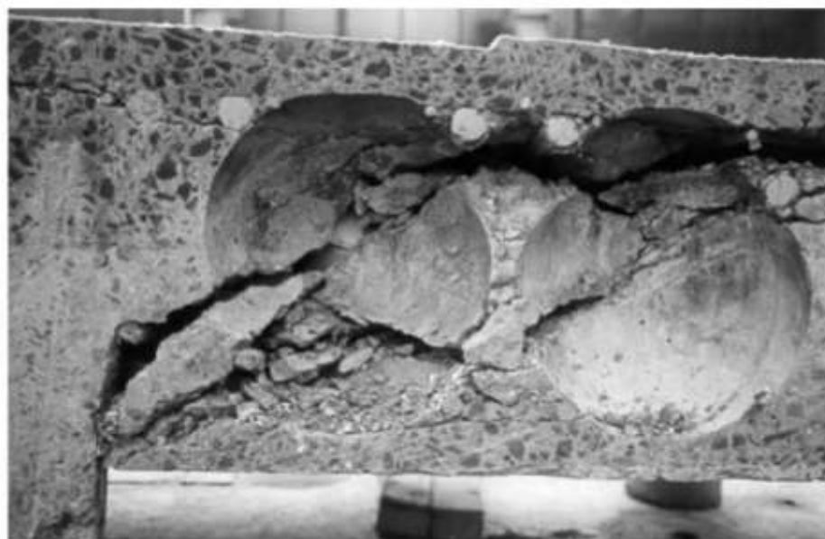
شکل ۵: ترک خوردگی در نمونه آزمایشگاهی مورد بررسی توسط اشکنباخ و پففر [۲]
