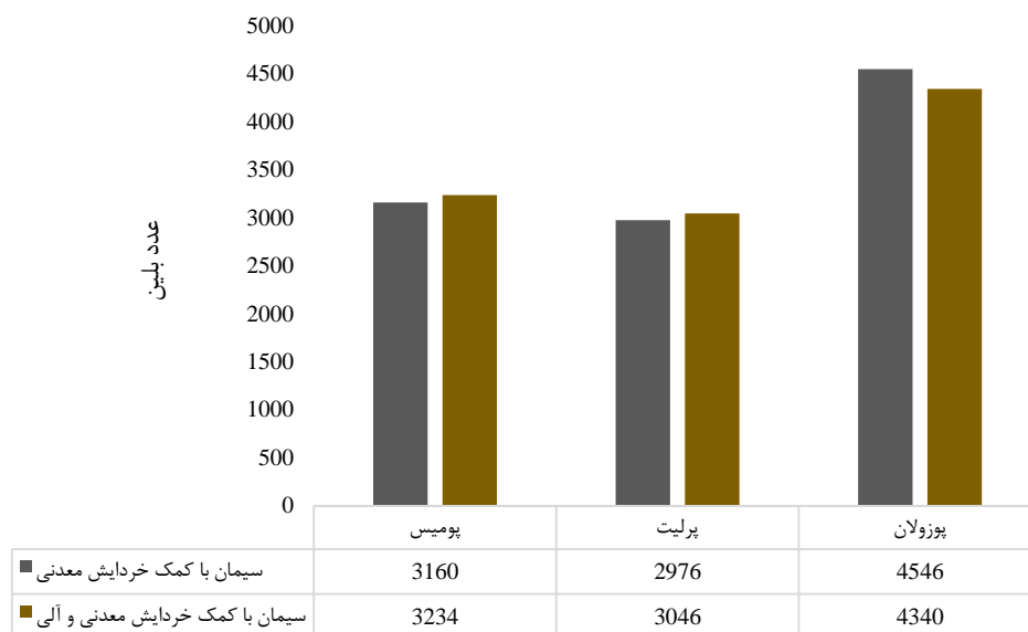
شکل ۴- عدد بلین در حالت استفاده از کمک ساینده‌های معدنی و حالت ترکیب کمک ساینده‌های معدنی و آلی در خردایش.
