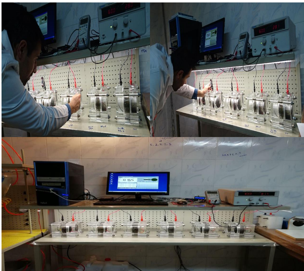
شکل ۵: آزمایش نفوذ تسریع شده یون کلراید (RCPT)
