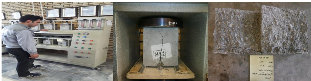
شکل ۹: آزمایش عمق نفوذ آب تحت فشار
