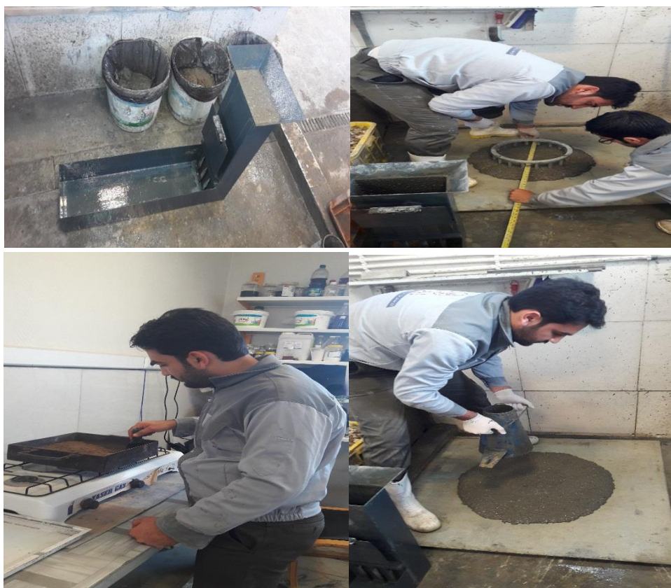
شکل ۴: عکس رئولوژی بتن خودتراکم، نمونه‌ها، شکستن نمونه‌ها
