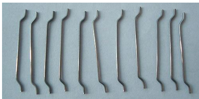
شکل ۱- الیاف فولادی دو سر قلاب استفاده شده در این پژوهش
