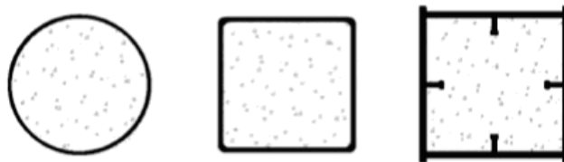
شکل (۱) - مقاطع پر شده با بتن CFT [۴]
