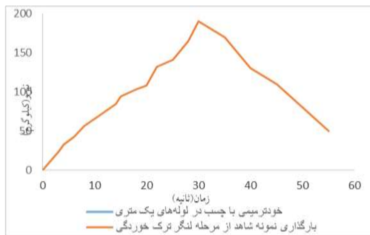
نمودار ۴- نمودار نیرو بر حسب زمان برای نمونه شاهد و نمونه ترمیم شده با روش خودترمیمی با لوله های یک
