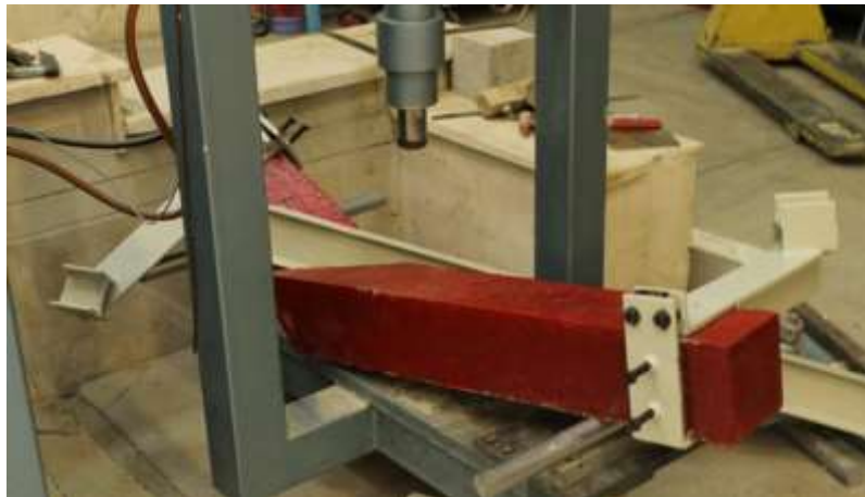
شکل ۹- تیر بتنی فاقد آرما تور، شکسته شده با زاویه ۴۵ درجه تحت بارگذاری پیچشی
