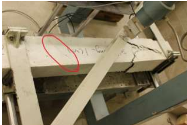
شکل ۱۱. نمونه ترمیم شده به روش خودترمیمی تحت بارگذاری ثانویه و ترک خوردن در محلی غیر محل ترک اولیه
