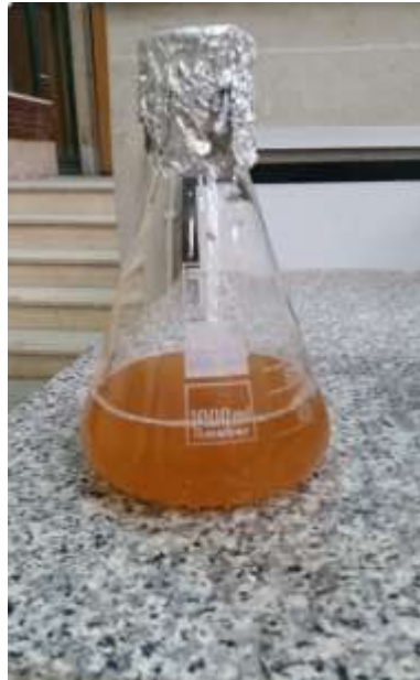
شکل ۷- باکتری آماده شده برای انجام ترمیم بتن به روش تزریق باکتری
