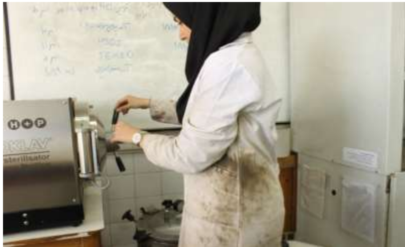
شکل ۳- قرار دادن محیط کشت در اتوکلاو به منظور از بین رفتن میکروب‌های احتمالی
