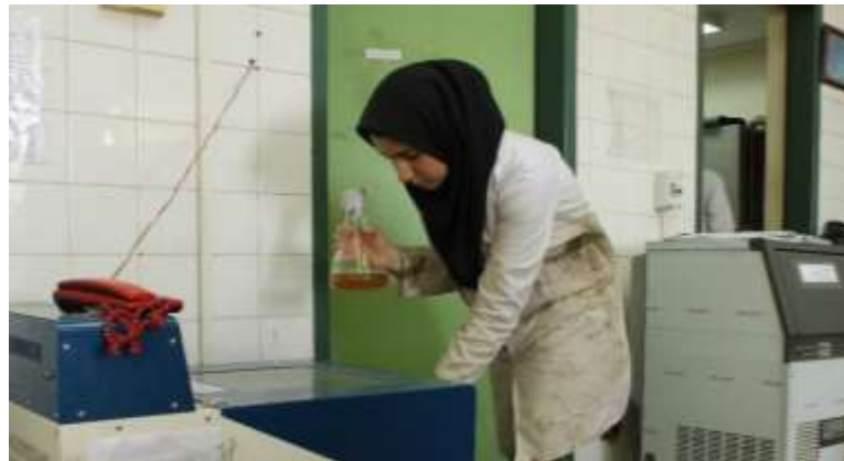
شکل ۵- قرار دادن باکتری همراه با محیط کشت در داخل لرزاننده به منظور تکثیر و رشد
