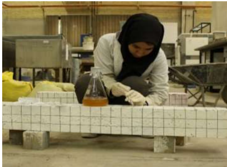
شکل ۱۰- تزریق باکتری به داخل ترک از طریق سرتگ انسولین یافته‌ها
