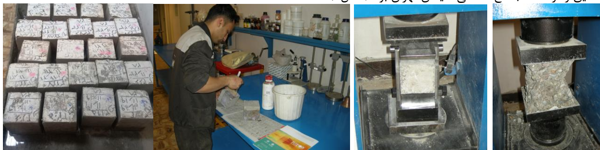
شکل ۳- نماهایی از عملیات آزمایشگاهی (از راست به چپ: تعیین مقاومت فشاری، مقاومت کششی، نرخ جذب آب)
