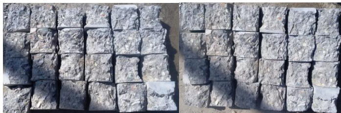
شکل ۵- بررسی ظاهری آزمون‌های تحت تنش فشاری (به ترتیب از راست به چپ: N35, N50, N60, N67, N70 و N80)
