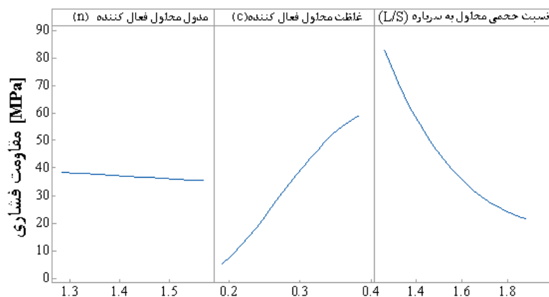
شکل ۲- میزان تاثیر مقادیر مورد بررسی بر مقاومت فشاری بتن‌های ساخته شده
