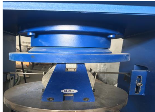
الف) تجهیزات بتن شکن ب) نتایج شکل (4) - نتایج آزمایش مقاومت کششی بتن های اصلاح شده با پلیمر
