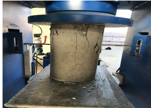
الف) تجهیزات بتن شکن ب) نتایج شکل (3)- آزمایش مقاومت فشاری بتن های اصلاح شده با پلیمر
